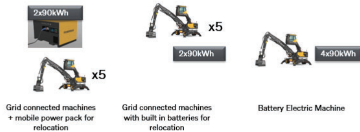
Figur 61, System med delning av batterilagret mellan maskiner
