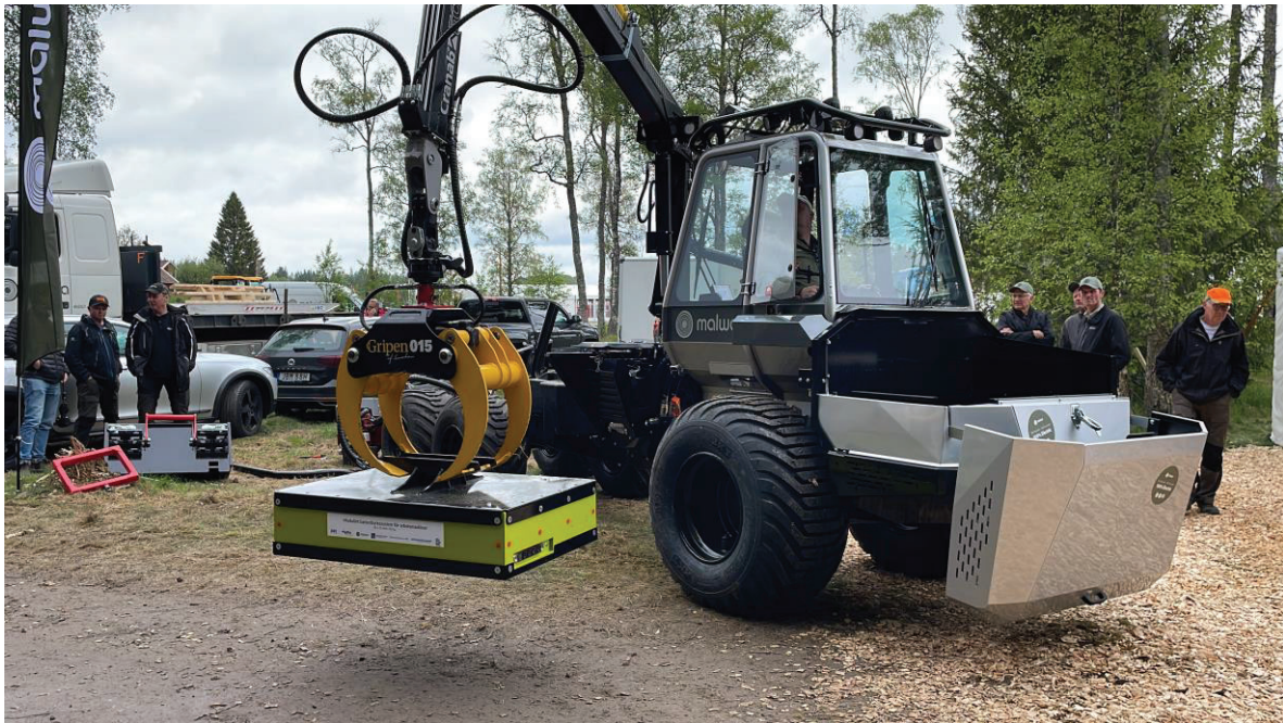
Figur 3. Malwa Combi 560 är den skogsmaskin som byggts om till eldrift i projektet. I bilden visas när den lyfter sitt lösa batteri.
