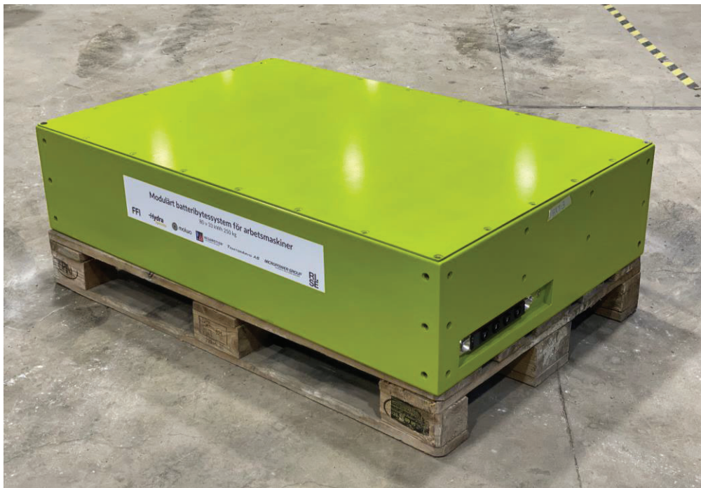
Figur 1. Bild på det batteripack som tagits fram i projektet. Stort som en EUR-pall, 330 kg, 28 kWh, 80v.
