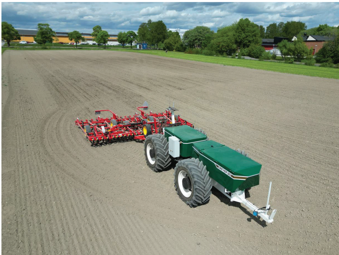
Figur 2. Drever 120 - maskinen som Traktorarvid AB designat och byggt som sedan byggts klart i projektet inklusive implementering av batterisystemet. Maskinen visar harvning med autonom styrning på RISE Testbädd Digitaliserat Jordbruk utanför Uppsala.
