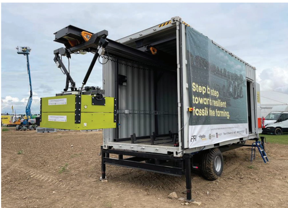
Figur 4. Batteribytesstationen är byggd i en 20-fotscontainer och kan automatiskt ladda och byta batterier på jordbruksmaskinen i projektet.
